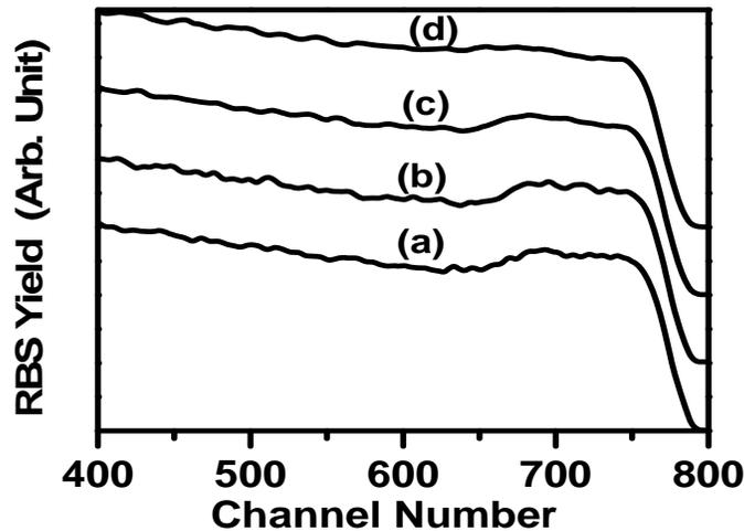
Figure 3. RBS Spectra of The GaAs Samples Implanted With 325 Kev Mn<sup>+</sup> Ions Implanted GaAs For The fluence of (a)  $1 \times 10^{15}$  (b)  $5 \times 10^{15}$  (c)  $1 \times 10^{16}$  (d)  $2 \times 10^{16}$  ions  $\text{cm}^{-2}$ .
